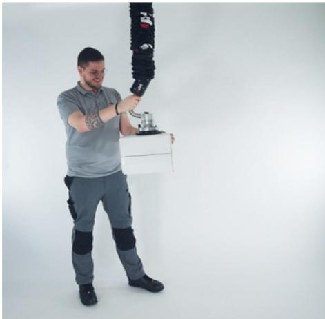
Der **FIPALIFTswift** ist ein besonders ergonomischer Schlauchheber mit einer Tragfähigkeit von bis zu **40 kg**.
