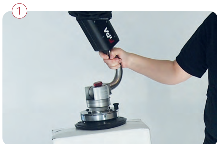
FORMHAND – frei verformbares Greifkissen
